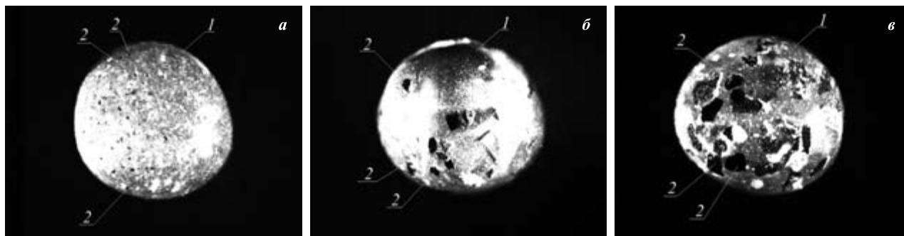
Рис. 7. Видеogramмы капель воды ( R_d = 3 мм) с включениями углеродистых частиц: а — L_m = 50 \div 70 мкм; б — L_m = 250 \div 300 мкм; в — L_m = 450 \div 500 мкм; 1 — капля; 2 — углеродистые частицы [91]
