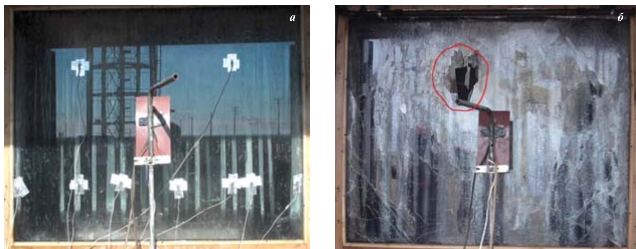
Рис. 5. Образец триплекса 5-1-5 после испытания с орошением обогреваемой стороны (начало испытания) (а) и необогреваемой стороны (б)
