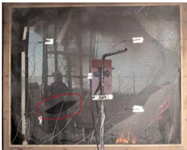
Рис. 4. Образец триплекса 5-1-5 после испытания без орошения
