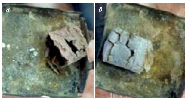
Рис. 2. Образование пенококсowego каркаса ЛКМ на поверхности образцов древесины после огневых испытаний: a — система № 1 на алкидной основе; b — система № 2 на алкидной основе с водоотталкивающими добавками
