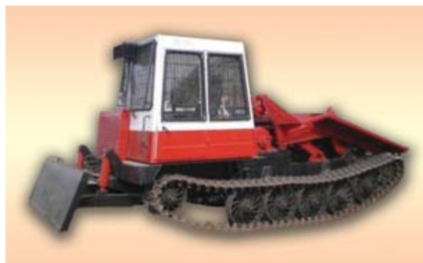
Рис. 2. Лесопожарный трактор ЛТ-4ЛП
