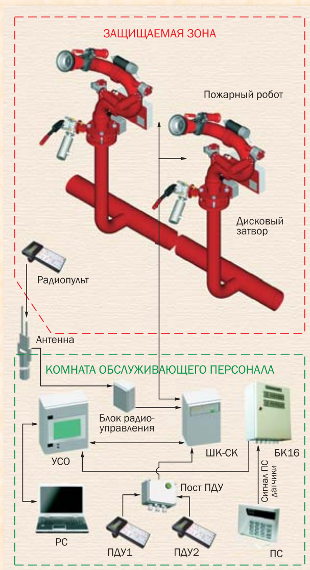
Рис. 3. Функциональная схема управления пожарными роботами
