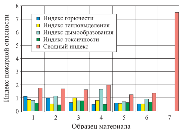
Рис. 1. Индексы пожарной опасности для испытываемых образцов ПКМ и образца сравнения
