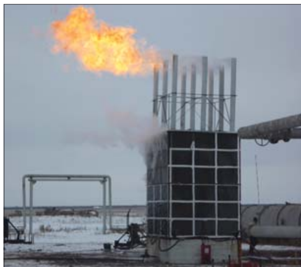
Рис. 3. Эксперименты по оценке размеров пожароопасного облака, образующегося при выходе газа через трубы
