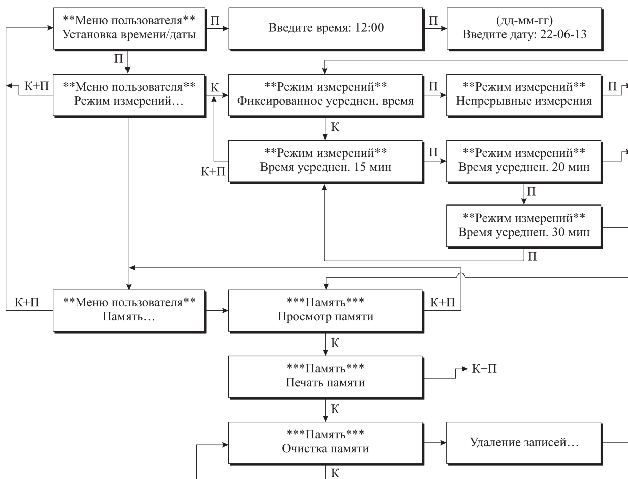
Рис. 2. Блок-схема работы газоанализатора "ГАНК-4": К — кнопка набора кода; П — кнопка пуска
