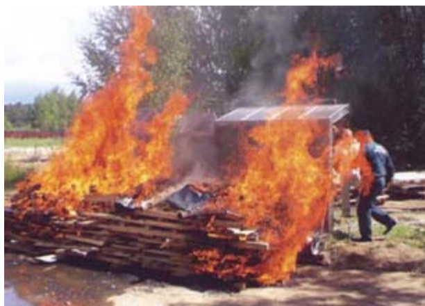
Рис. 1. Огневые испытания теплозащитного экрана
