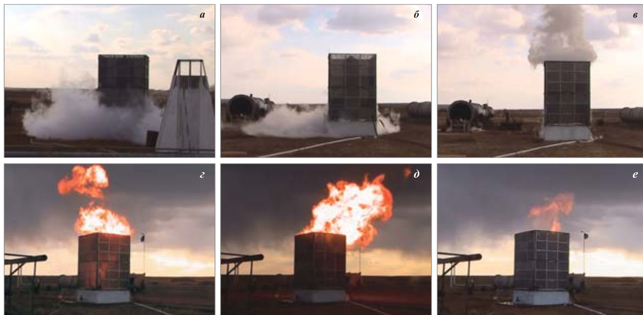
Рис. 4. Фрагменты экспериментов с проливом СПГ во внутреннем объеме защитного ограждения: а — через 10 с с момента подачи СПГ; б — то же, через 60 с; в — в момент подачи воды на экран; г — в момент поджига газа внутри ограждения; д — через 5 мин с момента поджига газа; е — в момент прекращения подачи газа
