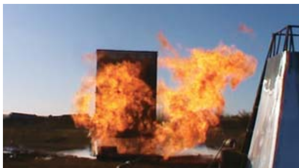
Рис. 3. Горение пролива СПГ в непосредственной близости от защитного экрана
