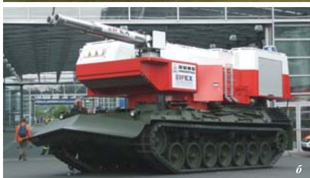
Рис. 2. ГБПМ “Импульс-3М” с башенной 50-ствольной установкой (разработка и производство КТЦ и ДРМЗ по патенту автора) (а) и немецкая ГБПМ на шасси танка “Леопард” (б)
