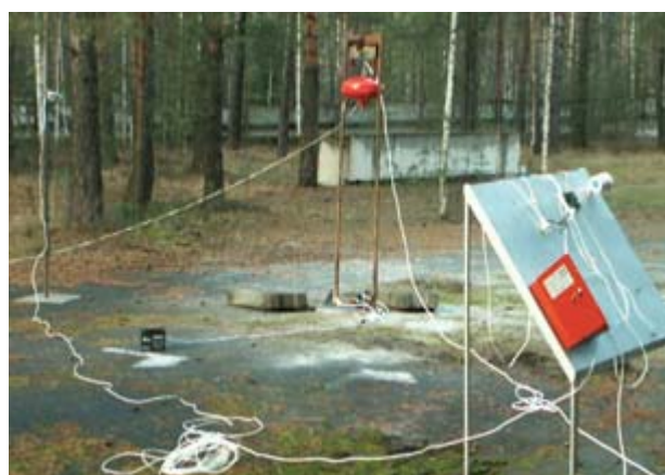
Рис. 5. Внешний вид и момент испытаний автоматической установки тушения образцов ТРТ
