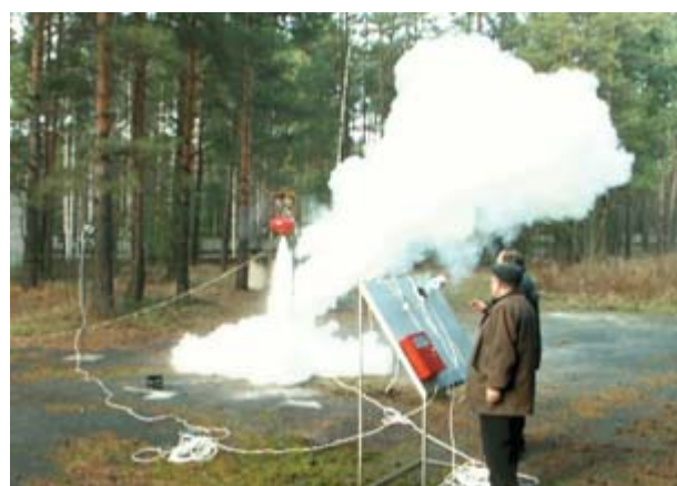
Рис. 5. Внешний вид и момент испытаний автоматической установки тушения образцов ТРТ
