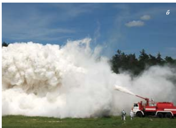
Рис. 4. Одноствольный пневмоимпульсный модуль на салазках (а) и пневматическая порошковая машина ОП-5 с 5 т ОП (б)
