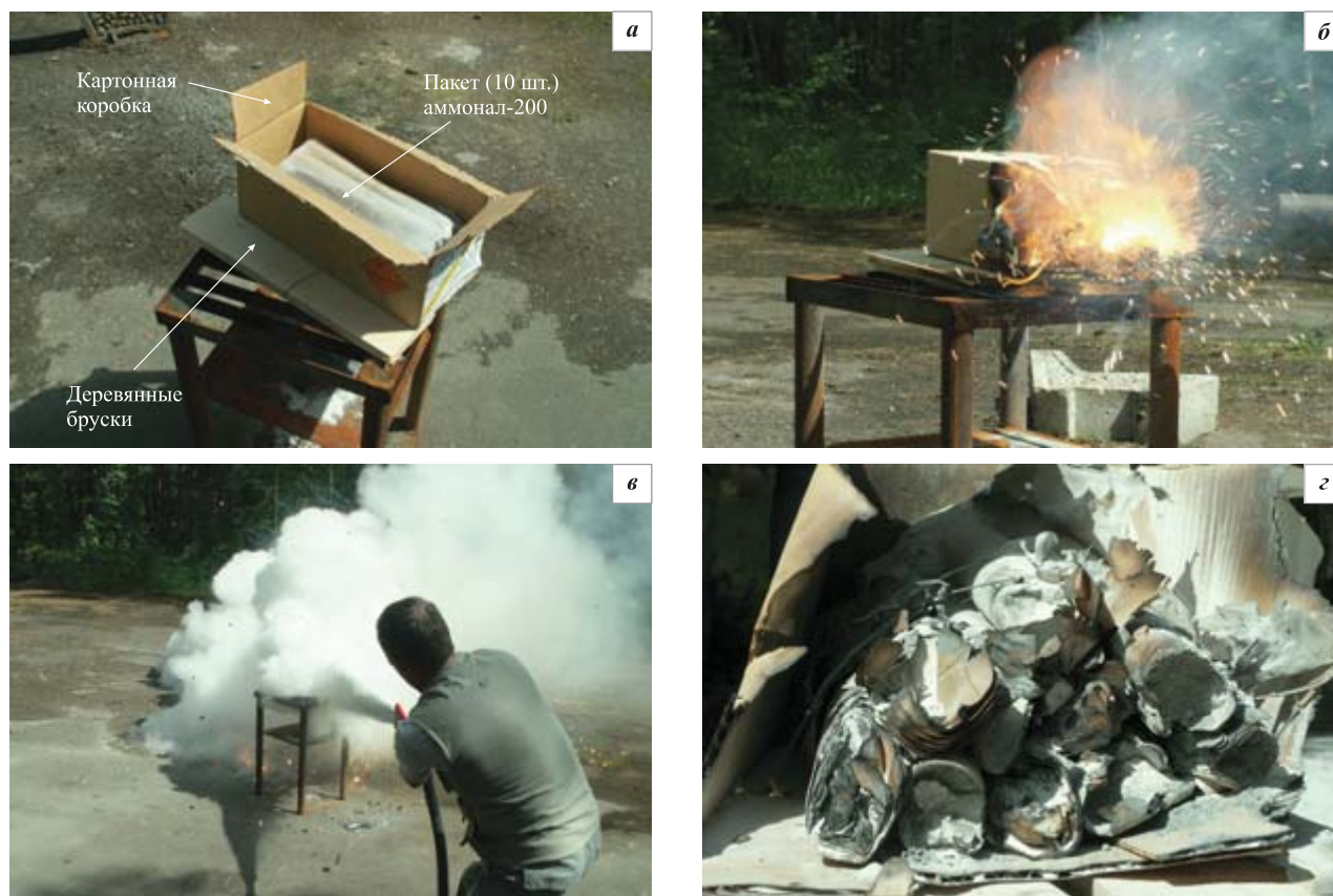
Рис. 7. Тушение аммонала-200 аэрозольно-порошковым огнетушителем ОПАН-50М (ОП-40(г)): а — до начала эксперимента; б — \tau = 60 с, интенсивное горение 10 пакетов аммонала-200 после розжига газовой горелкой; в — \tau = 100 с, начало тушения аэрозольно-порошковой струей огнетушителя ОПАН-50М; г — потушенные пакеты аммонала-200
