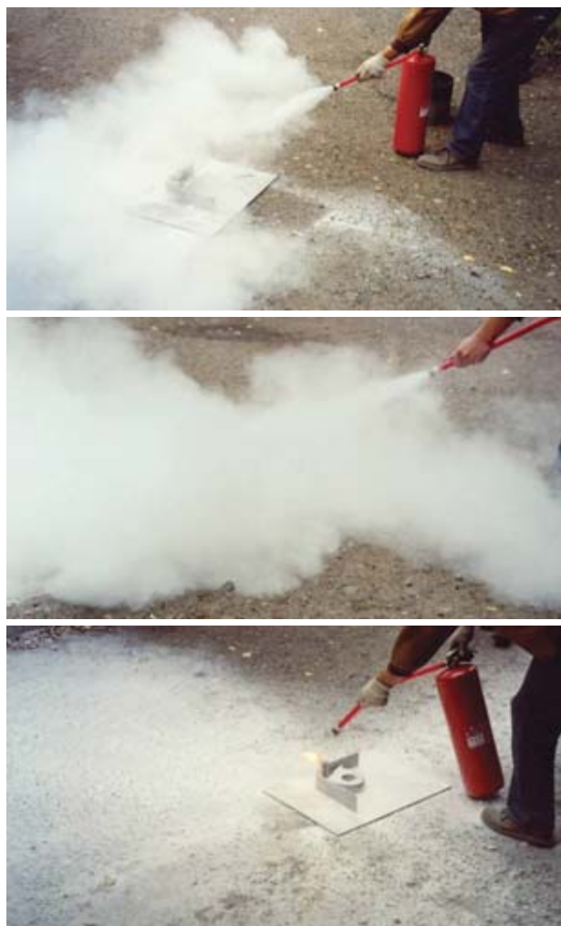
Рис. 1. Повторное возгорание образца металлизированного ТРТ после тушения огнетушащим порошком Вексон-АВС
