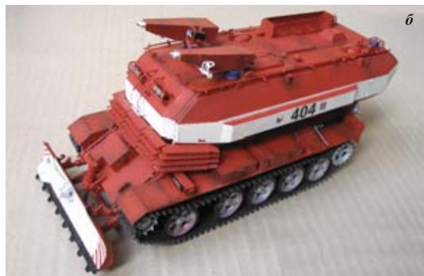
Рис. 1. Гусеничная пожарная гидравлическая машина ГПМ-54 на разбронированном шасси танка Т-54 (а) и модификация ГПМ — чешская SPOT-55 (б)
