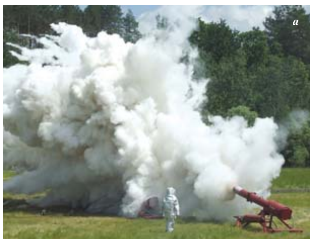
Рис. 3. Опытный 10-ствольный модуль, монтируемый на прицепах, шасси, палубах катеров и кораблей
