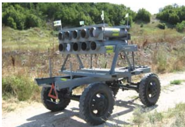
Рис. 3. Опытный 10-ствольный модуль, монтируемый на прицепах, шасси, палубах катеров и кораблей
