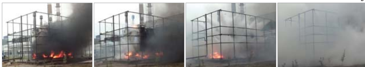
Рис. 2. Кадры видеосъемки трех различных натурных испытаний на 3, 6, 9 и 12-й секундах (слева направо) подачи \text{CO}_2 с момента открытия запорно-пускового устройства МИЖУ
