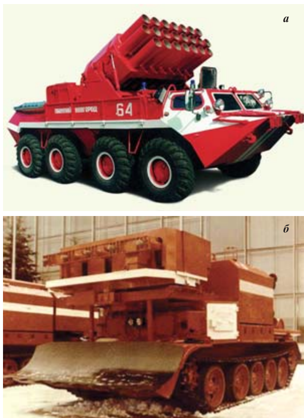
Рис. 5. Импульсная 22-ствольная установка порохового распыления “Ветлуга” (Горьковский автозавод) (а) и 5-ствольная установка порохового распыления воды на базе танковых огнеметов (ВНИИПО, Москва) (б)
