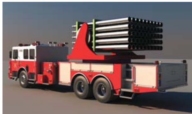
Рис. 7. Вариант компоновки ММ на шасси пожарного автомобиля
