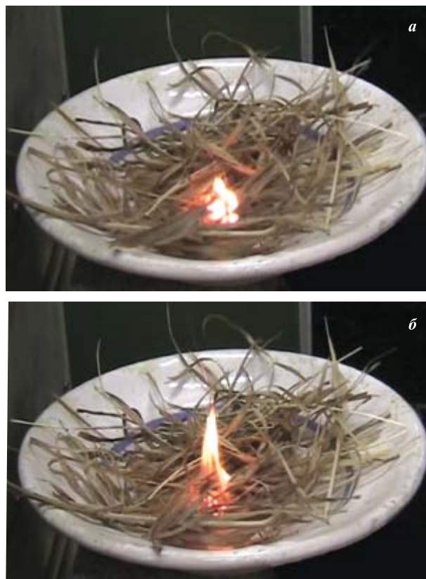
Рис. 3. Характерные кадры видеопленки процесса зажигания травяной ветоши нагретой до высоких температур частицей: а — воспламенение морфологических частей растительности в приповерхностном слое; б — проникновение частицы вглубь и воспламенение нижерасположенной листовой пластины с последующим объединением микрофакелов пламени
