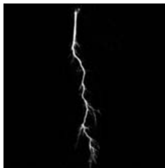
Рис. 5. Разряд статического электричества с электрода радиусом кривизны 25 мм: структура разрядных образований — стебель, ветви, область волновой ионизации
