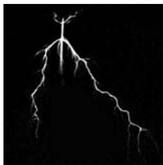
Рис. 4. Разряд статического электричества с электрода радиусом кривизны 35 мм: структура разрядных образований — двухступенчатый стебель с узлом, ветви, область волновой ионизации
