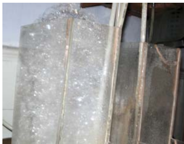
Рис. 6. Высота столба пены (14–15 см) в опытном аэротенке (708/1) с 1-х по 60-е сутки проведения эксперимента по оценке биоразлагаемости концентрата Forafac 1157N (перфторгексилэтилсульфонамидобетаин, C_{\text{вх}} = 1 мг/л по перфторПАВ, \text{ХПК}_{\text{вх}} = 10 мг/л; \Delta\text{ХПК}_{\text{вых}} = 0 )
