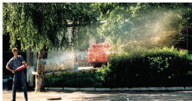
Рис. 2. Распыление 1,5 кг мокрого песка на 25 м по горизонтали и до 14 м в высоту под углом до 75°
