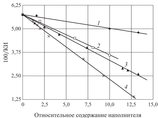
Рис. 5. Зависимость воспламеняемости высоконаполненного полиэтилена от относительного содержания наполнителя k : 1 — \text{PbO} ; 2 — \text{Al} ; 3 — \text{Al}_2\text{O}_3 ; 4 — \text{LiF}
