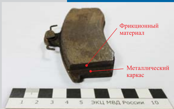
Термический анализ тормозных колодок
