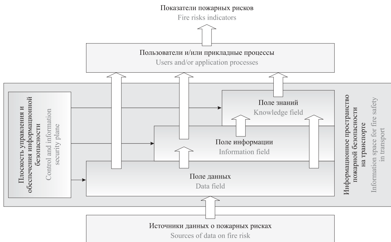
Рис. 1. Архитектурное построение информационного пространства пожарной безопасности на транспорте
