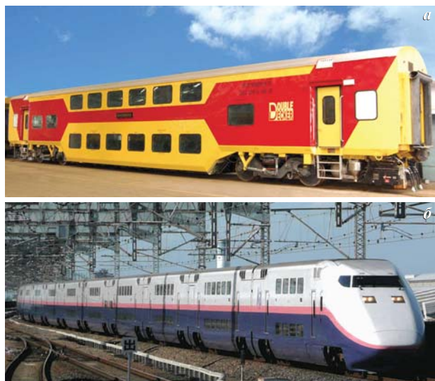
Рис. 2. Современные двухэтажные вагоны — индийский (а) и высокоскоростной японский (б)
