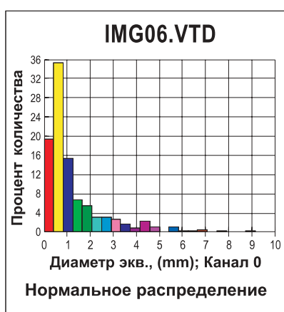
Рис. 4. Пенокок на основе меламиноформальдегидной смолы (к-3) и гистограмма распределения в нем пор ( K_{bc} = 84 )
