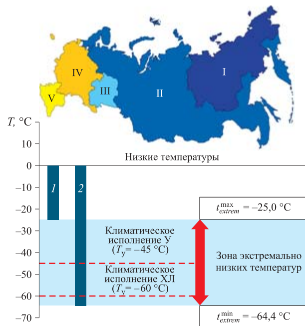
Рис. 9. Распределение нижней границы климатического исполнения техники У и ХЛ в зоне экстремально низких температур января в холодных регионах России
