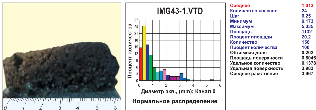
Рис. 6. Пенококсы покрытия на акрилстирольной смоле (а-5) и гистограмма распределения в нем пор ( K_{\text{вс}} = 54 )
