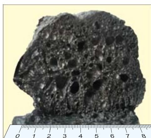
Рис. 4. Пенокок на основе меламиноформальдегидной смолы (к-3) и гистограмма распределения в нем пор ( K_{bc} = 84 )
