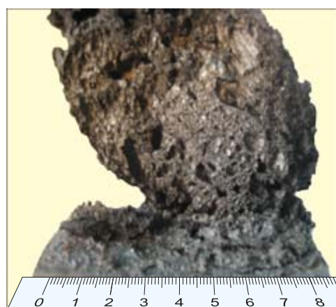
Рис. 3. Пенокок покрытия на основе меламиноформальдегидной смолы (к-2) и гистограмма распределения в нем пор ( K_{bc} = 80 )
