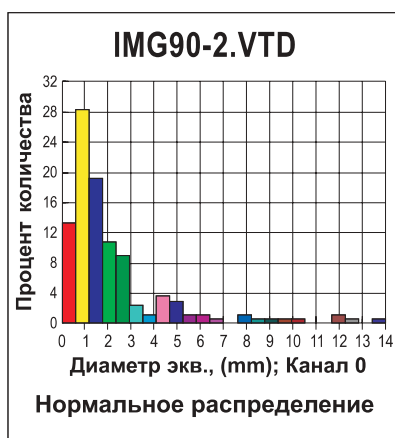
Рис. 2. Пенококк покрытия на основе меламинаформальдегидной смолы (к-1) и гисторамма распределения в нем пор ( K_{\text{вс}} = 87 )
