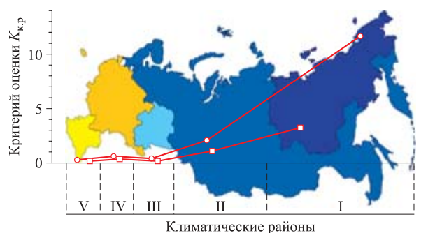
Рис. 7. Распределение отказов элементов насосно-рукавной системы пожарного автомобиля вследствие влияния низких температур
