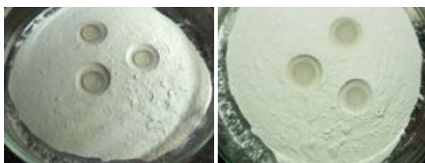
Рис. 5. Тест на водоотталкивание огнетушащего порошка, обработанного методом совместного помола с ГМД-3 в концентрации 2 %: слева — наличие капель воды на поверхности порошка в конце эксперимента (через 120 мин); справа — скатывание капель при наклоне чашки Петри
