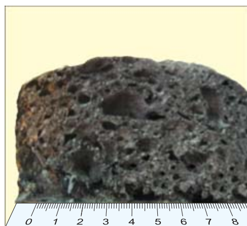
Рис. 5. Пенокок покрытия на акрилстирольной смоле (а-4) и гистограмма распределения в нем пор ( K_{bc} = 80 )
