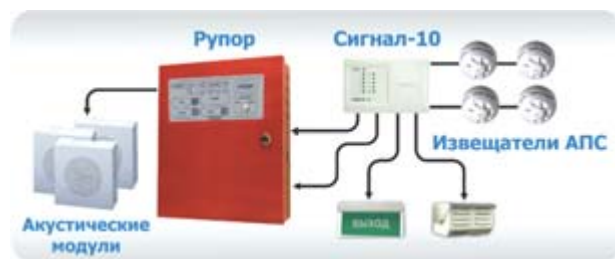
Рис. 4. Пример СОУЭ 3-го типа с одной зоной оповещения
