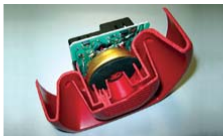
Рис. 10. Устройство звукового оповещателя
