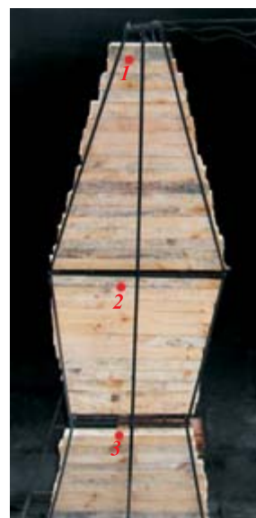
Рис. 2. Схема (а) и вид (б) макета пожарной нагрузки для натурных огневых испытаний с целью исследования эффективности пассивной противопожарной защиты: 1, 2, 3 — термпары; 4 — сосновый брус; 5 — металлический каркас; 6 — модельный очаг класса В
