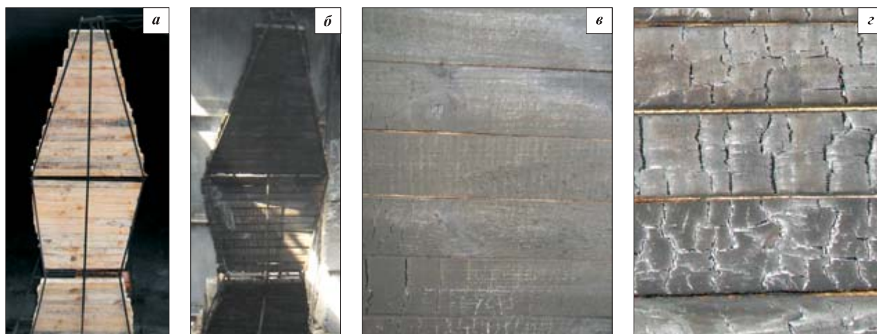
Рис. 3. Фрагмент натурных огневых испытаний деревянных брусков макета пожарной нагрузки, обработанных ДСА-2: а, б — вид макета пожарной нагрузки соответственно до и после испытаний; в, з — состояние деревянных брусков макета пожарной нагрузки соответственно после 300 и 720 с воздействия очага класса В
