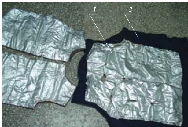
Рис. 1. Съемный теплоизолирующий чехол для пожарного насоса ПН-40УВ: 1 — теплоотражательный слой; 2 — два теплоизолирующих слоя
