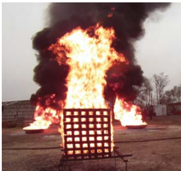
Тестирование порошковых огнетушителей ОП-4: на переднем плане разгорается очаг 2А, на заднем — выгорают два очага 55В
