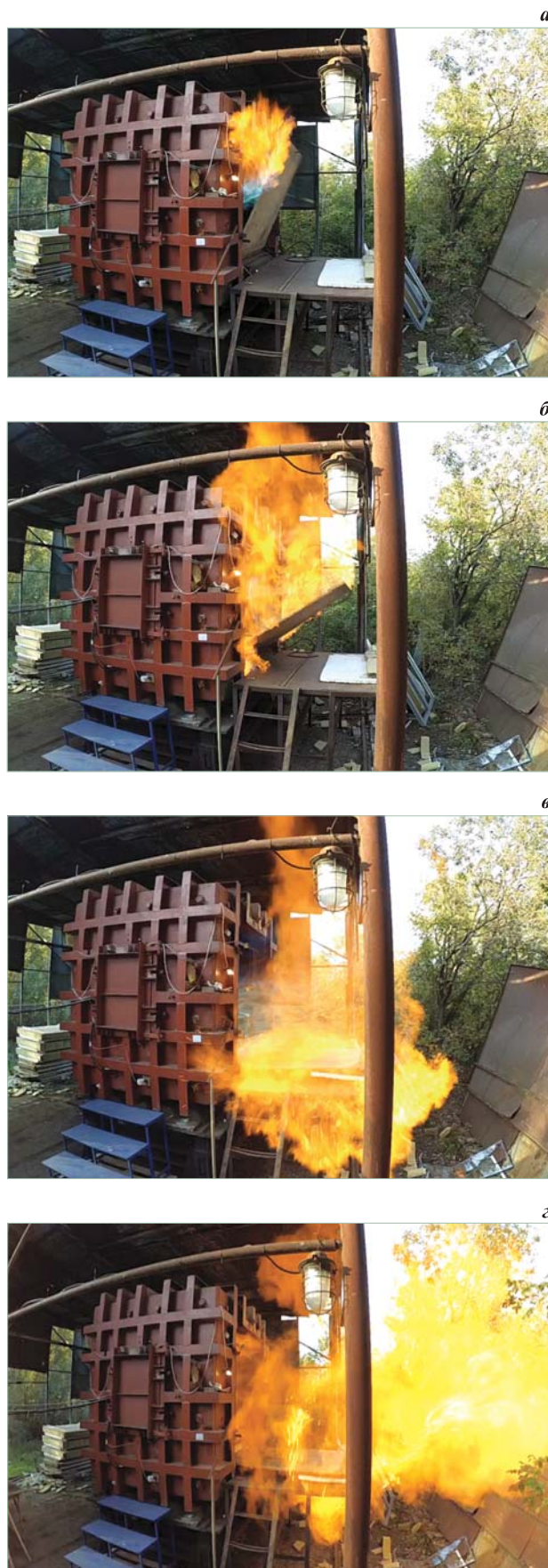
Рис. 2. Видеокадры взрыва при зажигании смеси в точке 2 в разные моменты времени от начала взрыва: а — 0,12 с; б — 0,20 с; в — 0,30 с; з — 0,70 с
