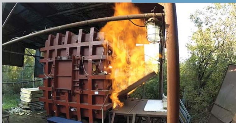
Вибрационное горение при газовом взрыве в незамкнутом объеме
