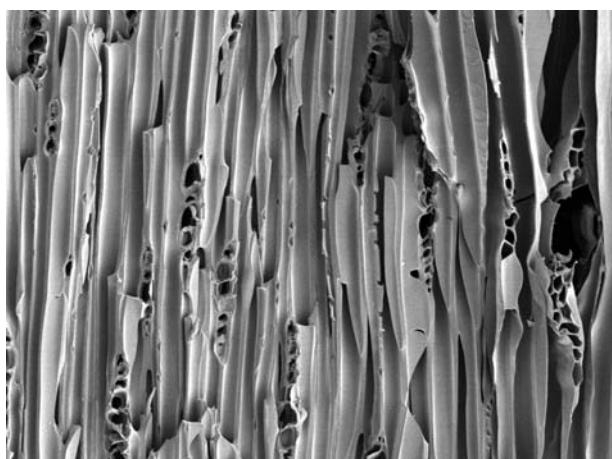
Рис. 8. Карбонизованный слой древесины, модифицированной ПФА-1, при увеличении 200\times
