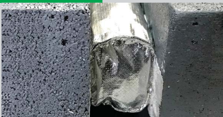
Огнезащита деформационных и линейных швов
