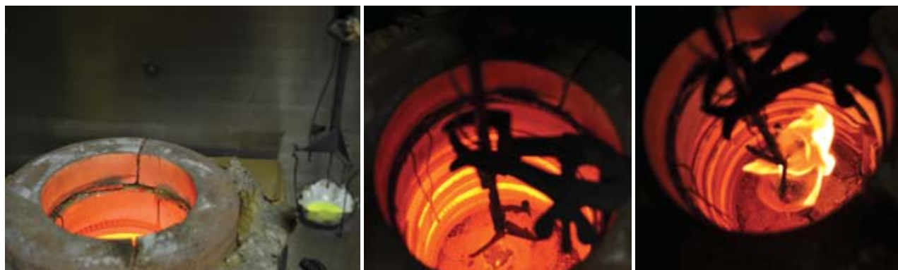
Рис. 2. Экспериментальное определение температуры самовоспламенения в установке ТЭП
