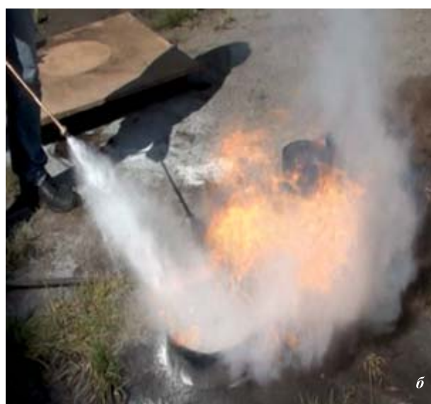
Рис. 3. Фрагменты тушения бензина порошком дисперсностью 80 мкм: а — воздух, увлекаемый струей порошка, раздувает факел пламени; б — формируется слой порошка над горячей поверхностью бензина
