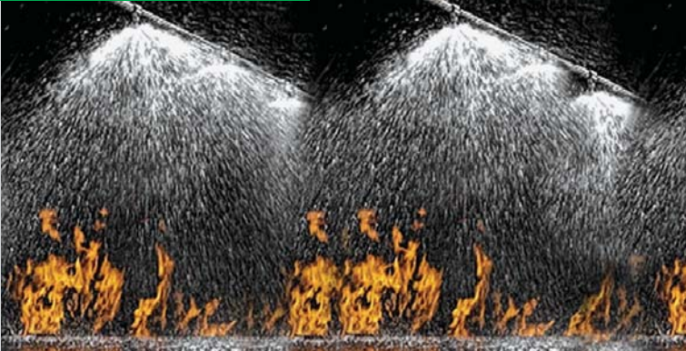
Экранирование тонкораспыленной водой излучения от пожара
