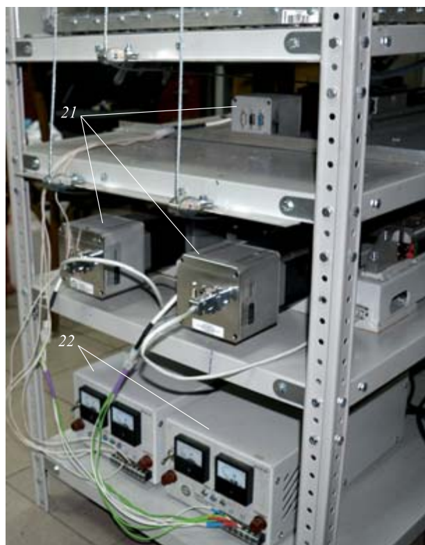
Рис. 2. Изображение установленных на экспериментальном стенде моторизованных координатных механизмов (обозначения см. на рис. 1)
