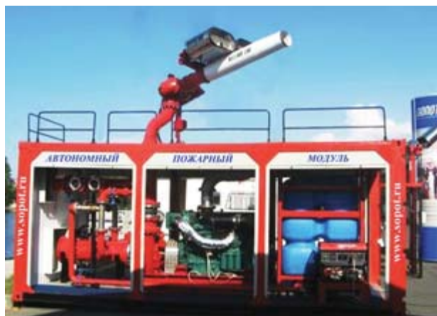
Рис. 1. Автономный пожарный модуль контейнерного типа с УКТП "ПУРГА-300"
