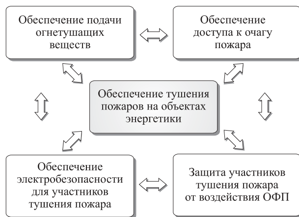
Рис. 3. Схема обеспечения тушения пожара на объекте энергетики
