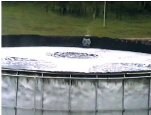
Рис. 5. Открытые участки поверхности нефти, расположенные над местом входа пены в горючую жидкость через насадки, установленные под углом 120^\circ
