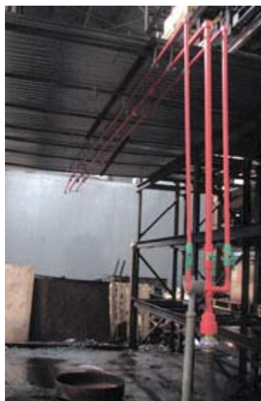
Рис. 7. Общий вид испытательного стенда для испытаний труб на пожаростойкость в помещении практически неограниченного объема
