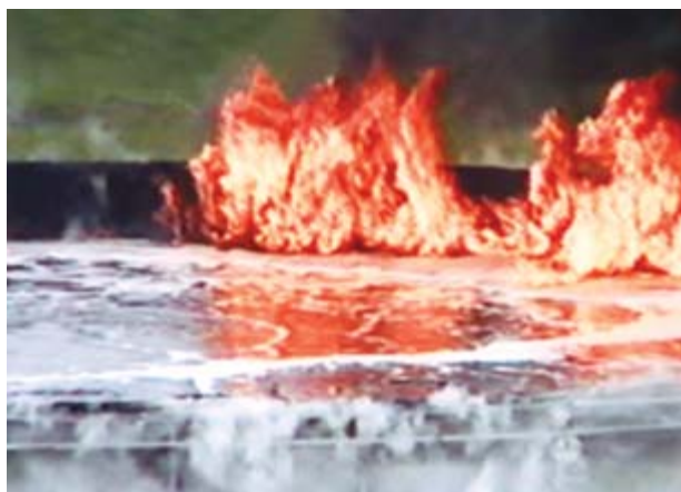
Рис. 15. Локальный участок над местом подъема пены на горящую поверхность нефти
