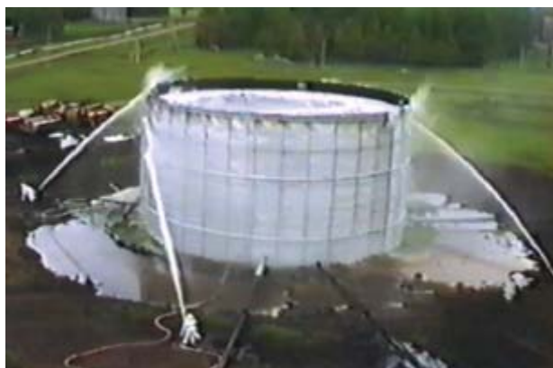
Рис. 2. Фрагмент огневых испытаний: пламя в резервуаре потушено подачей пены низкой кратности в основание резервуара через один трубопровод с насадками в центре резервуара; пять линейных вводов пены расположены равномерно по окружности резервуара
