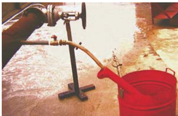
Рис. 12. Демонстрация узла отбора пены при испытании генератора на кратность пены: металлическая трубка опущена в емкость до уровня 3 см выше дна
