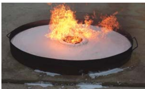
Рис. 16. Иллюстрация изолирующего действия слоя пены после тушения пламени бензина, находящегося в цилиндре в центре противня с бензином
