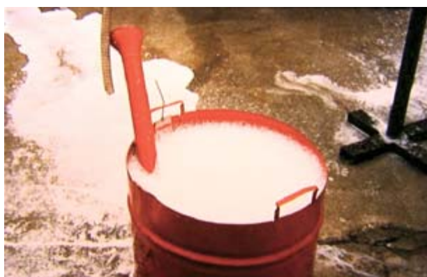
Рис. 13. Демонстрация мерной емкости, заполненной анализируемой пеной, поданной в основание емкости во избежание захвата воздуха снаружи
