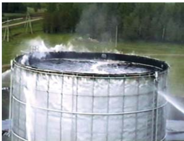
Рис. 3. Заключительный этап тушения пламени легкой нефти подачей пены низкой кратности, полученной из пенообразователя "Легкая вода", через два трубопровода, расположенные с противоположных сторон резервуара
