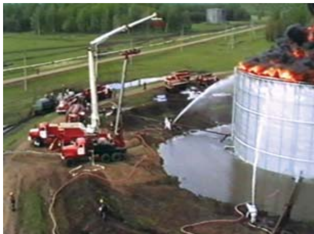
Рис. 1. Фрагмент огневых испытаний системы подслоного тушения пламени легкой нефти в резервуаре
