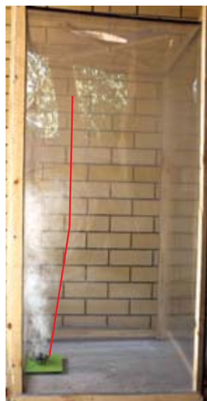
Рис. 6. Характерные фотографии течения внутри экспериментального объема при расположении горящего материала у стены ( h = 1,5 м)
