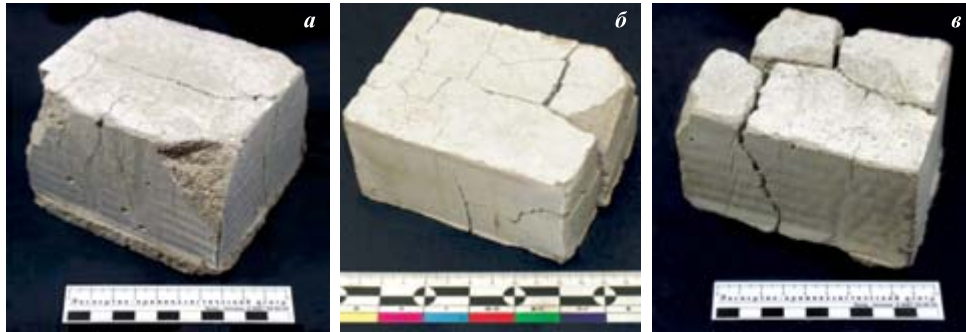
Рис. 1. Образцы бетона из цемента разных марок, отожженные в течение 60 мин при различной температуре: а — М200 при 700 °С; б — М400 при 700 °С; в — М200 при 1000 °С
