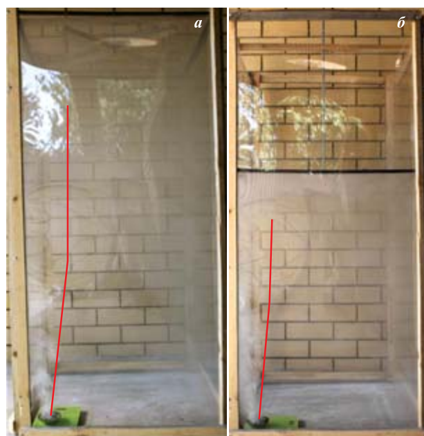
Рис. 5. Характерные фотографии течения внутри экспериментального объема при расположении горючего материала в углу пола помещения: а — h = 1,5 м; б — h = 1,0 м
