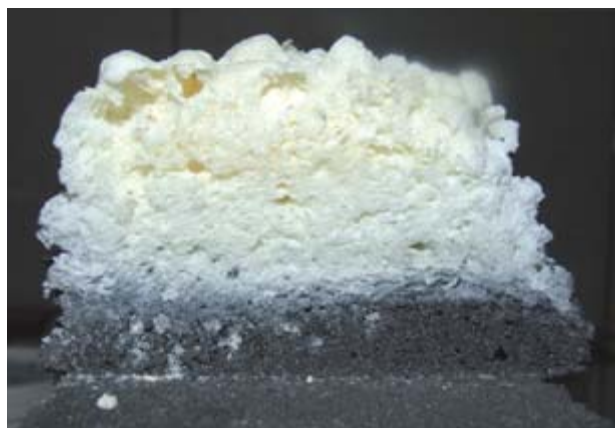
Рис. 1. Покрытие НЕОФЛЭЙМ®513 толщиной 1 мм после испытания в условиях стандартного пожара
