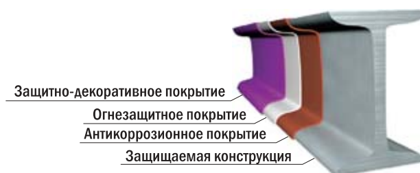
Рис. 4. Система комплексного покрытия
