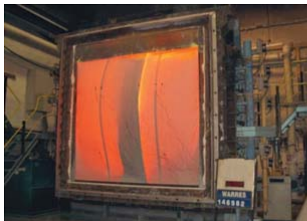
Рис. 25. Камера для проведения огневых испытаний противопожарных штор
