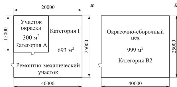
Рис. 1. План цеха обработки металлических заготовок с выделением (а) и без выделения (б) окрасочного участка
