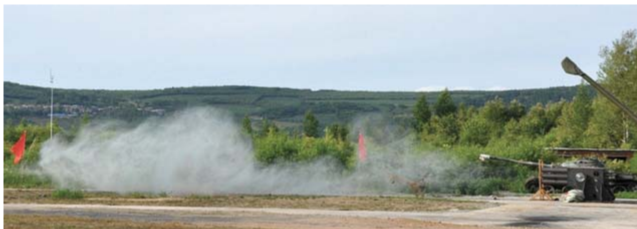
Рис. 3. Реализация второго механизма — распыление 20 кг песка выстрелом из трех стволов на дальность до 45 м
