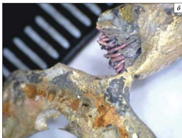
Рис. 2. Повреждения кабельного наконечника провода массы автомобиля Lada 21144: a — общий вид; б — увеличение
