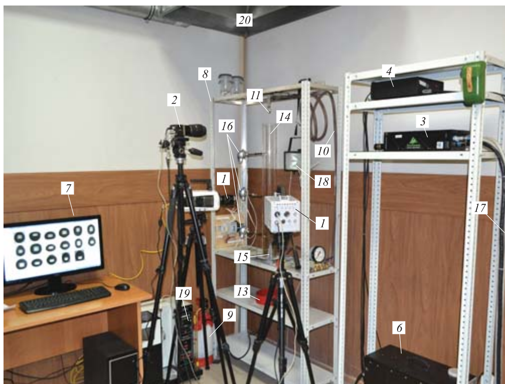
Рис. 1. Схема ( a ) и внешний вид ( б ) экспериментальной установки: 1 — высокоскоростная видеокамера; 2 — кросскорреляционная камера; 3 — двойной твердотельный импульсный лазер; 4 — синхронизатор ПК, кросскорреляционной камеры и лазера; 5 — световой “нож”; 6 — генератор лазерного излучения; 7 — ПК; 8 — штатив; 9 — емкость с водой; 10 — канал подачи воды; 11 — распылитель; 12 — распыленная вода; 13 — уловитель; 14 — цилиндр из жаростойкого светопрозрачного материала; 15 — полый цилиндр с горючей жидкостью во внутреннем пространстве; 16 — термопары; 17 — канал движения охлаждающей жидкости лазера; 18 — прожектор; 19 — нагревательная установка; 20 — нагнетательная система; 21 — пульт включения/отключения нагнетательной системы
