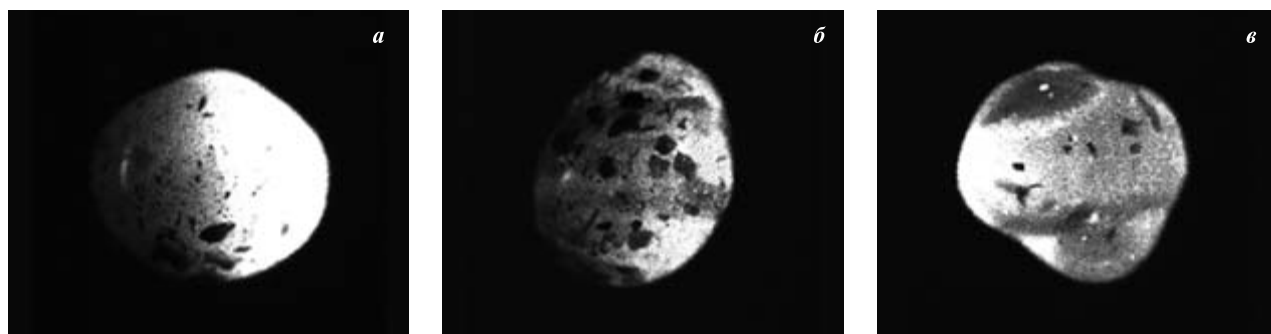
Рис. 4. Видеogramмы каплей воды ( r_2 = 3 мм) с включениями углеродистых частиц на выходе из высокотемпературной газовой среды ( T_f = 1050 К)
