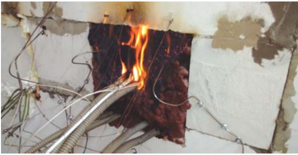
Рис. 4. Прорыв пламени на необогреваемой поверхности заделочного материала образца № 4
