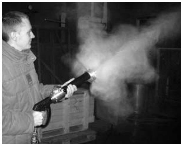
Рис. 5. Демонстрация работы с малорасходным пожарным стволом высокого давления
