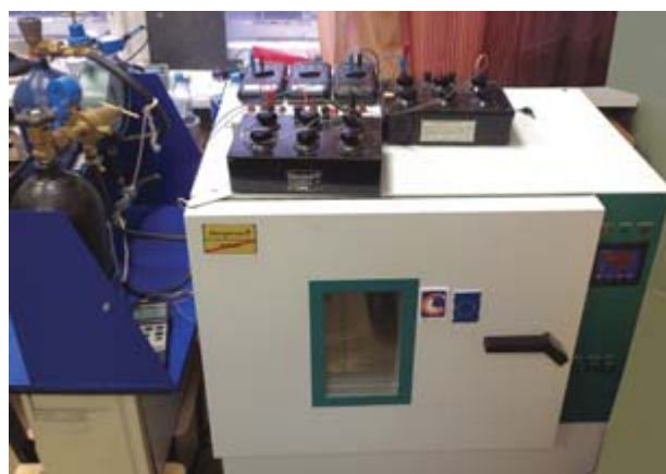
Рис. 4. Испытательный стенд с камерой тепла-холода типа КТХ-74
