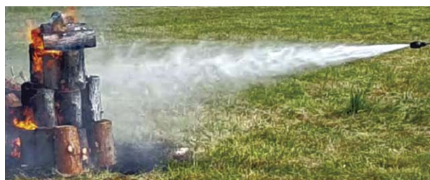
Рис. 7. Действие тонкораспыленной водяной завесы на дистанции 3...4 м в момент t = 0:09:25 при тушении модельного очага пожара (пример 2)
