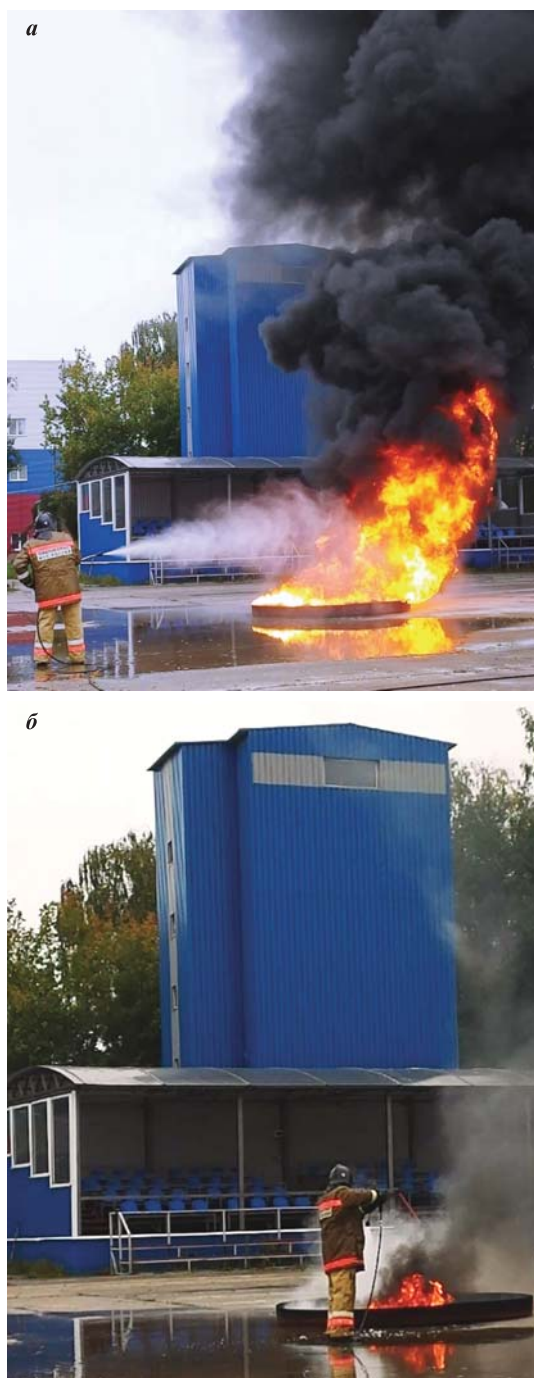
Рис. 2. Модельный очаг пожара ранга 233В (155 л бензина в поддоне диаметром 3 м): а — в начале тушения; б — через 1,5 мин после начала тушения
