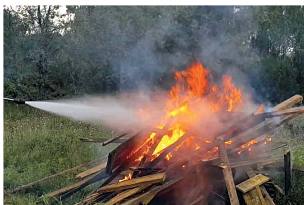
Рис. 10. Действие тонкораспыленной водяной завесы на дистанции 1,5...2,0 м в момент t = 0:10:47 при тушении модельного очага пожара (пример 3)
