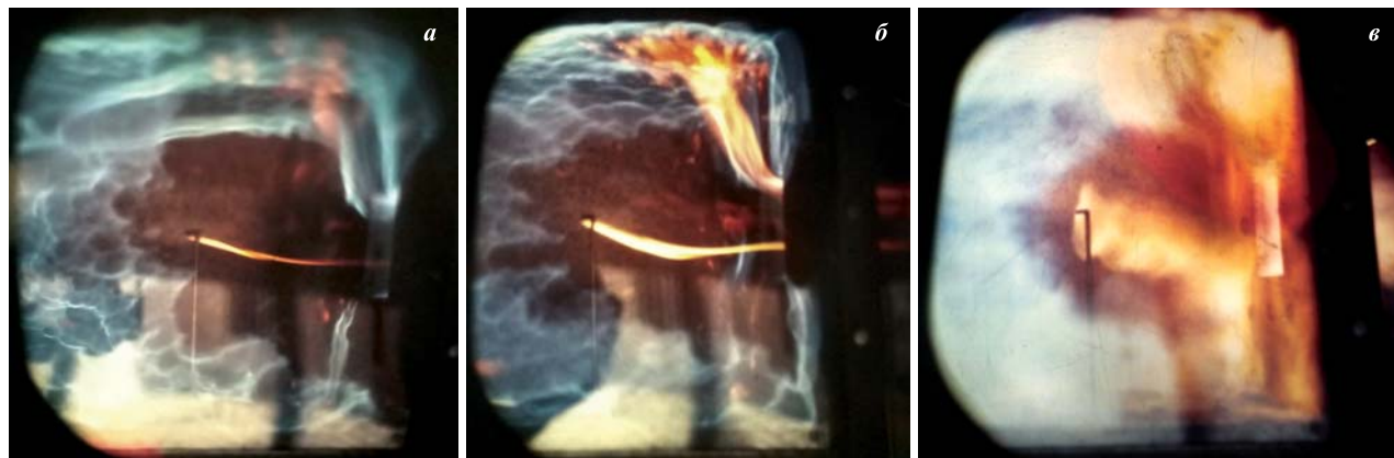
Рис. 3. Процесс вибрационного горения газа внутри камеры с прерывистым истечением газов
