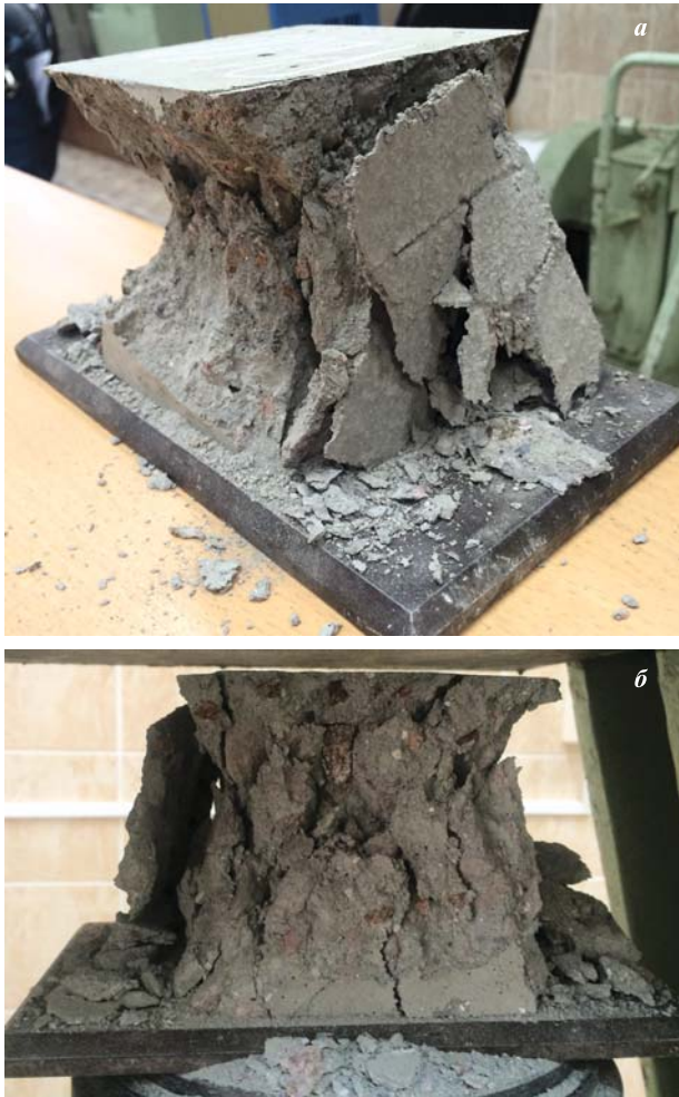
Рис. 1. Вид образцов бетона без добавки (а) и с добавкой фибры (б) после проведения эксперимента
