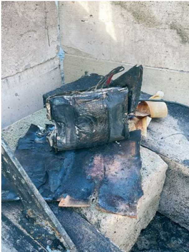
Рис. 8. ЛИА после экспериментов: a — № 1; b — № 2 Fig. 8. LIB after test: a — No. 1; b — No. 2
