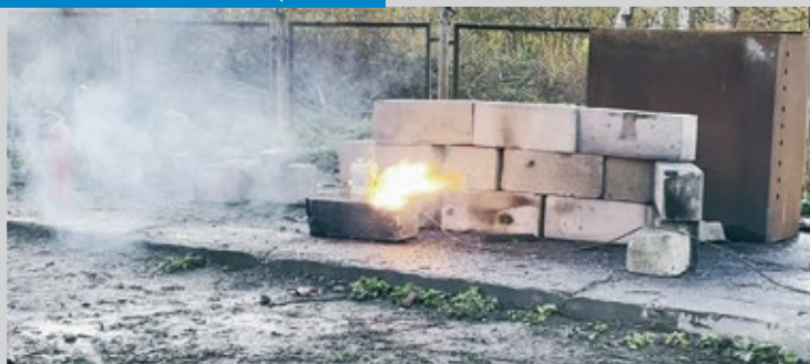
Экспериментальная оценка эффективности материалов, содержащих микрокапсулированный перфтор, для обеспечения пожарной безопасности литий-ионных аккумуляторных батарей
