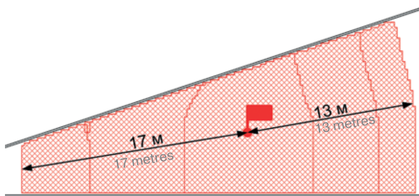
Рис. 18. Увеличение пути, пройденного огнем в условиях сужающихся стен Fig. 18. Increasing the fire path in narrowing wall conditions
