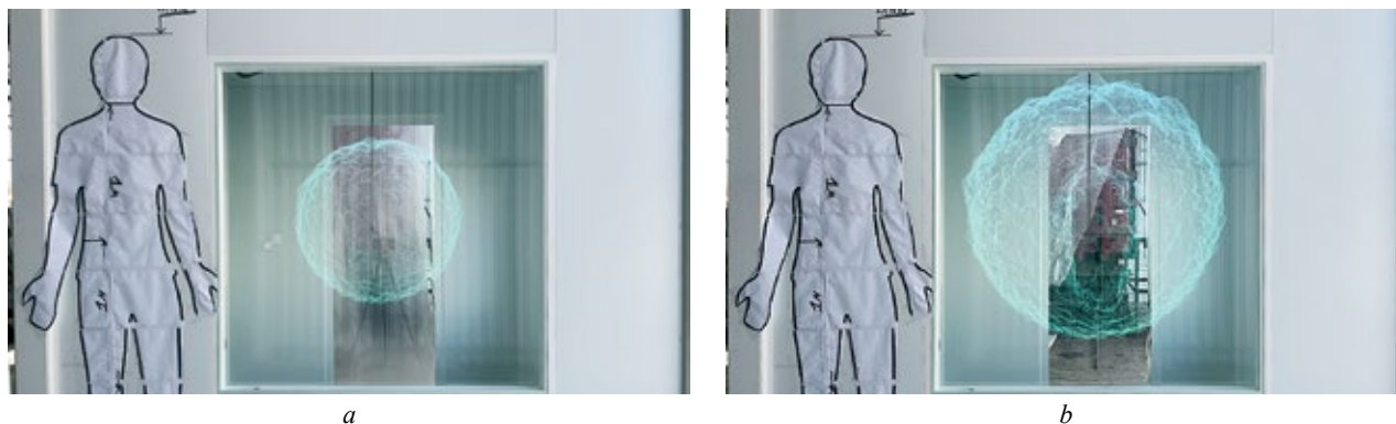
Рис. 18. Мгновенные фотографии фронта пламени однородной смеси, сформировавшейся за счет диффузии
