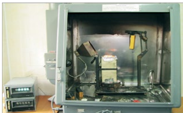
Рис. 1. Установка для определения эффективности огнезащитных составов «Керамическая труба»
