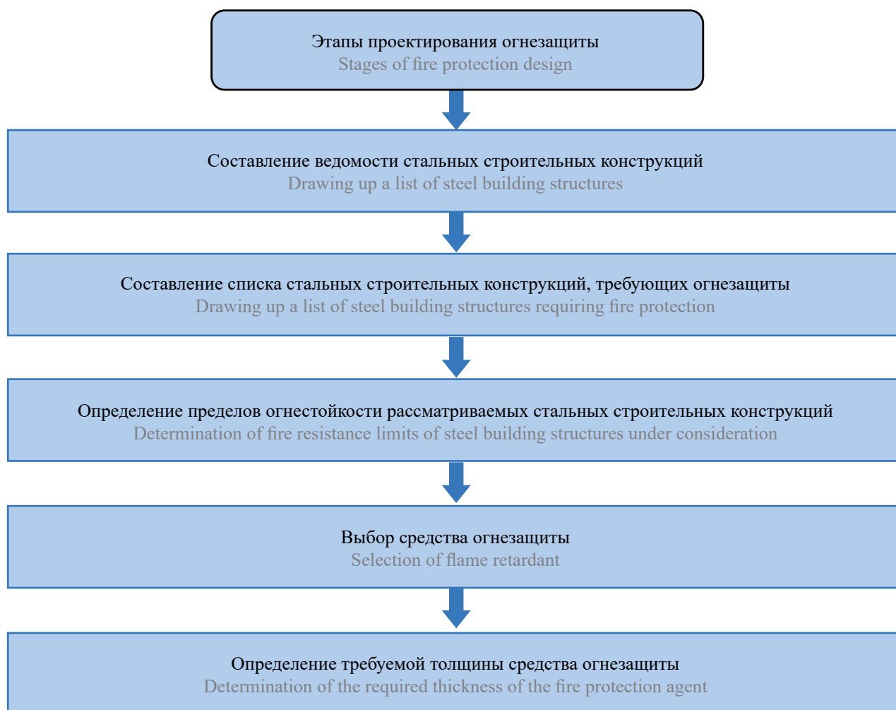
Рис. 3. Алгоритм проектирования огнезащиты строительных конструкций Fig. 3. Algorithm for designing fire protection of building structures
