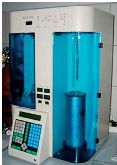
Рис. 2. Анализатор размера пор и площади поверхности NOVA 1200 (QUANTACHROME)
