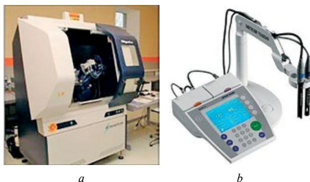
Рис. 1. Измерительное оборудование Комплексной лаборатории «НаноАналитика», КНИТУ, Казань: a — дифрактометр Rigaku SmartLab; b — измеритель комбинированный SevenMulti S47-K с модулями pH/ОВП и УЭП Fig. 1. Measuring equipment of the Integrated Laboratory «NanoAnalytics», KNITU, Kazan: a — Rigaku SmartLab diffractometer; b — SevenMulti S47-K combination meter with pH/ORP and SEC modules
