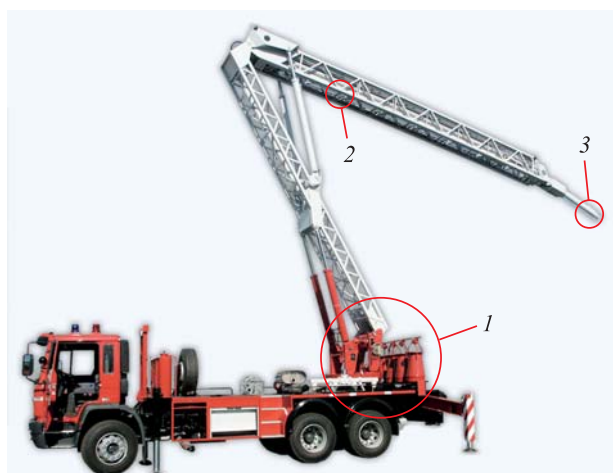
Рис. 5. Схема установки ствола “Пурга-73Д” и управления им с передвижной мобильной техники: 1 — пульт управления; 2 — электропривод; 3 — универсальный ствол с сервоприводом
