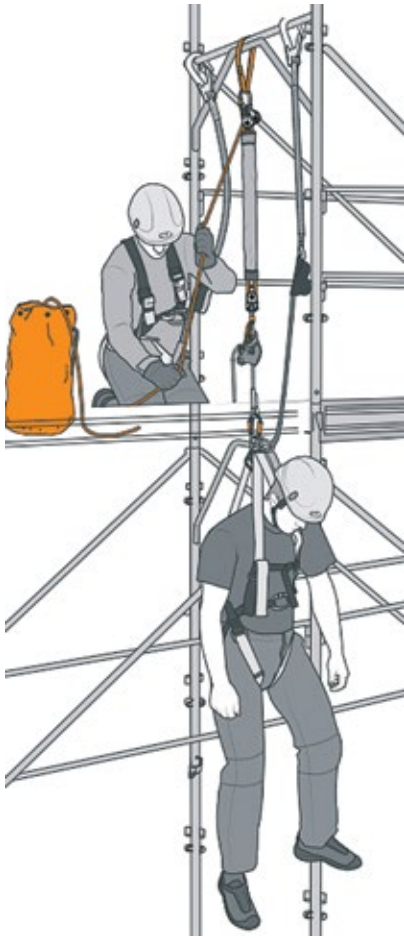
Рис. 3. Пример спасения пострадавшего с помощью системы, содержащей полиспаст
