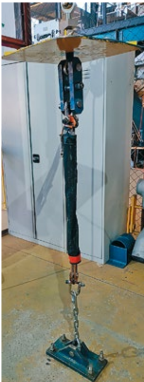
Рис. 7. Положение полиспаста при испытании статической прочности Fig. 7. Position of the block pulley during the static strength test
