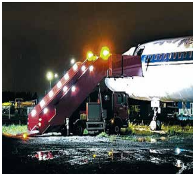
Рис. 12. Автотрап на вооружении СПАСОП в аэропорту Пулково (авторское фото)
