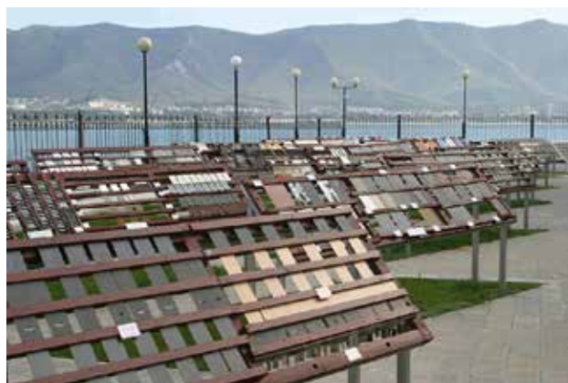
Рис. 6. Пример испытаний лакокрасочных покрытий для судов в естественных условиях
