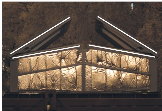
Рис. 7. Снимки с первой ( a ) и второй ( b ) кинокамер в момент реализации максимального взрывного давления (эксперимент 4) Fig. 7. Photos from the first ( a ) and second ( b ) movie cameras at the moment of maximum explosive pressure (Experiment 4)
