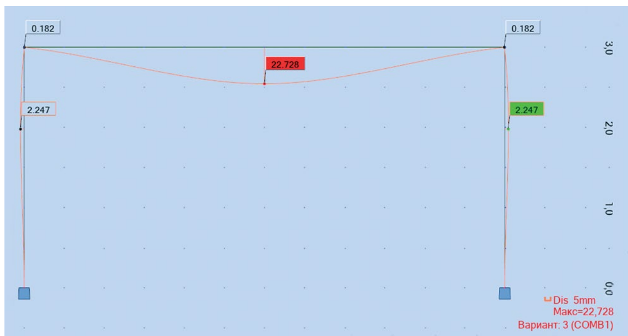
Рис. 7. Карта перемещений (расчет в Robot Structural Analysis Professional)
