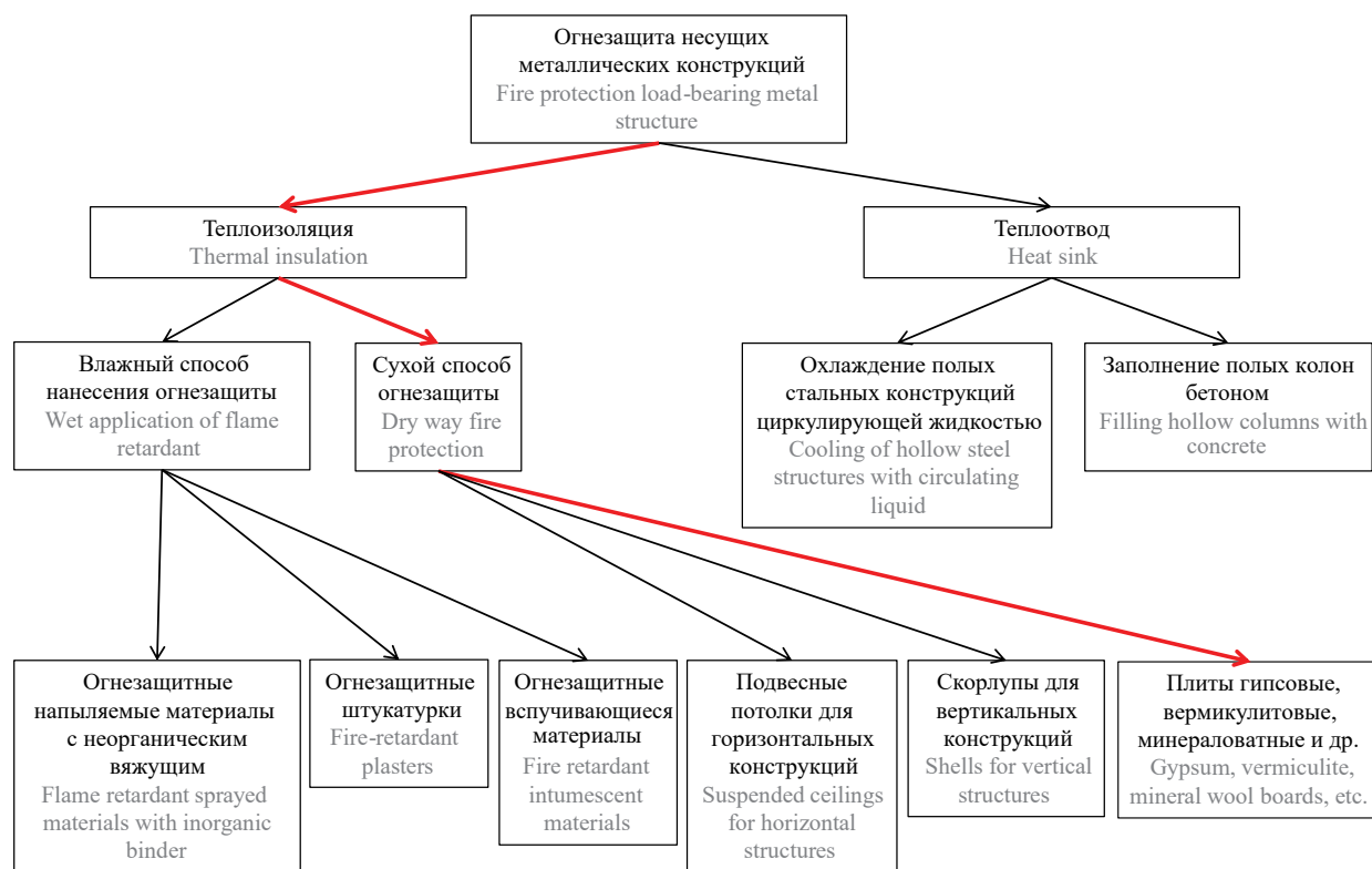
Рис. 1. Структурно-методологическая схема выбора огнезащиты для стальных конструкций [10]
