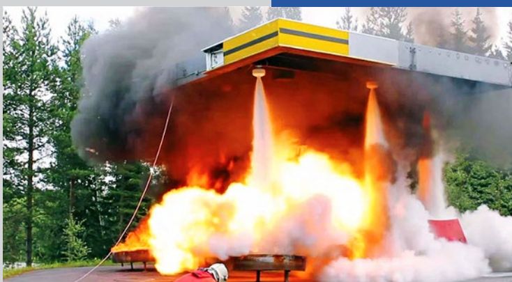
Тушение струйного горения газа автоматическими установками
