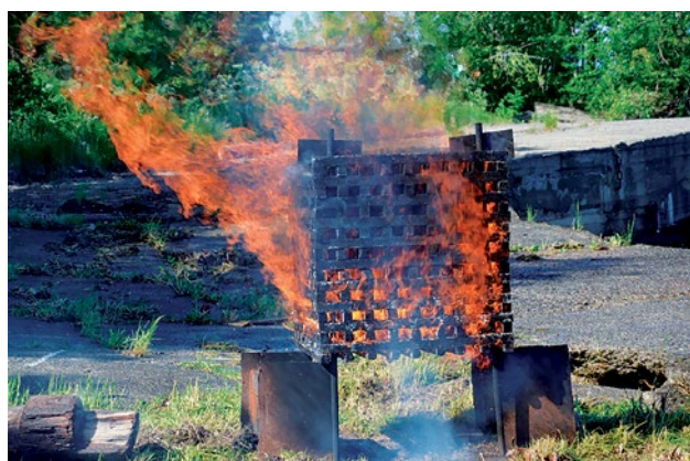
Рис. 2. Огневые испытания на модельном очаге по программе и методике испытаний АБМИ.112.00.000 ПМ
