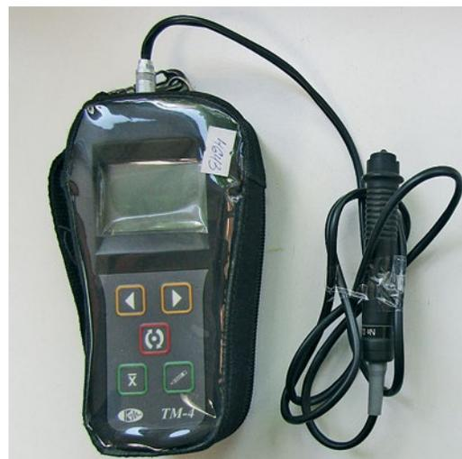
**Рис. 4.** Толщиномер покрытий ТМ-4
