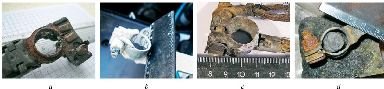
**Рис. 4.** Повреждения наконечников полюсных выводов аккумуляторных батарей: *a* — капли металла на внутренней поверхности; *b* — перенос материала на внутренней поверхности; *c* — изменение конструкции резьбового соединения; *d* — оплавление полюсного вывода при полностью затянутом резьбовом соединении
