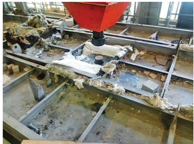
Рис. 3. Технологическое отверстие сверху горизонтальной печи для нагружения прессом во время огневого воздействия
