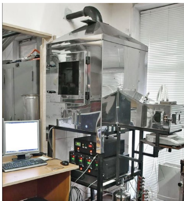
Рис. 3. Общий вид установки для определения пожарной опасности веществ и материалов при их термическом разложении Fig. 3. General view of the experimental unit used to determine the fire hazard of substances and materials in the process of thermal decomposition
