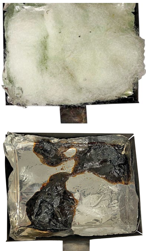
Рис. 6. Образец наполнителя до и после испытаний
