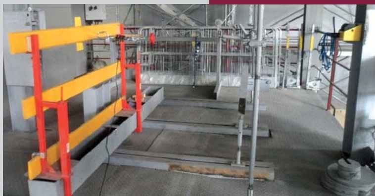
Испытания ограждений предохранительных инвентарных
