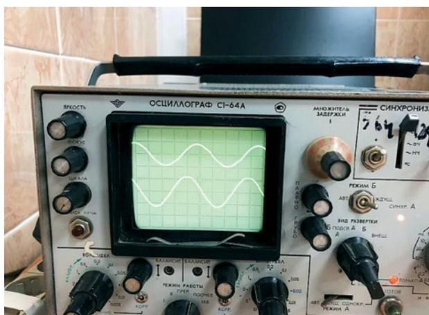
**Рис. 9.** Визуальный контроль формы сигнала с двухжильного нагревательного провода типа ПНСВ 1×1,2 на экране осциллографа в момент стабилизации сдвига фазы и изменения амплитуды сигнала на спектрограмме: 1 — образцовый сигнал; 2 — сигнал с выхода испытуемого образца
