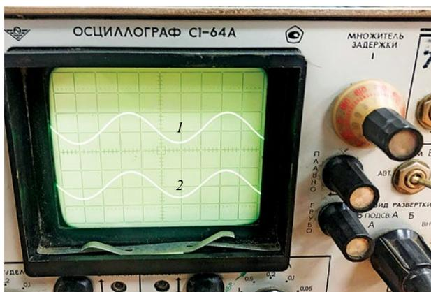
**Рис. 4.** Визуальный контроль формы сигнала на экране осциллографа: 1 — образцовый сигнал; 2 — сигнал с выхода испытываемого образца
