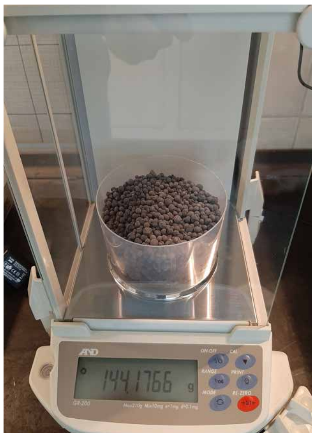
Рис. 4. Измерение убыли массы при испарении ацетона через СГП на аналитических весах
