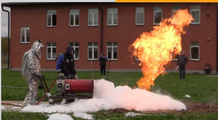
Применение пены для ликвидации горения сжиженного газа
