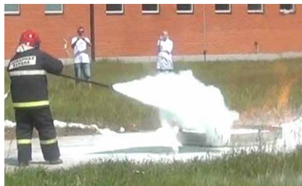
Рис. 10. Подача порошка из порошкового огнетушителя для дотушивания горящей поверхности СПГ, покрытой пеной Fig. 10. Powder application through a powder fire extinguisher to completely extinguish the burning surface of LNG covered in foam
