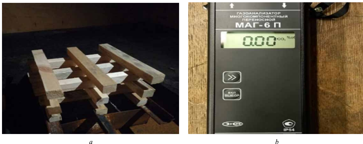
Рис. 6. Модельный очаг (а); газоанализатор (b)
