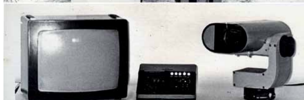
Рис. 4. РУП-С20-П1-2. Блок управления, телекамера ПТУ-45-1, устройство технического зрения и видео-контрольное устройство
