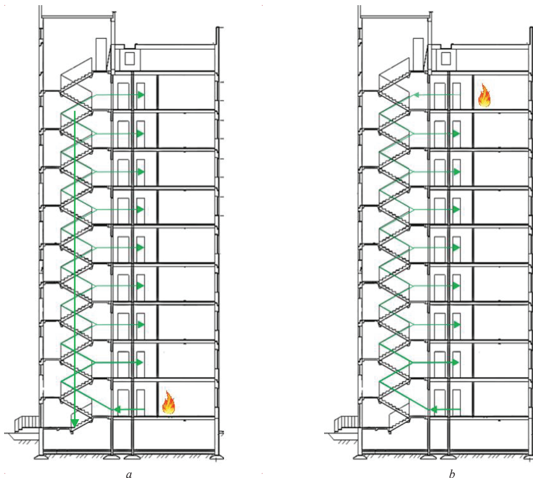
Рис. 7. Схема оповещения жителей о пожаре в пределах секции жилого дома: a — согласно первому сценарию; b — согласно второму сценарию
